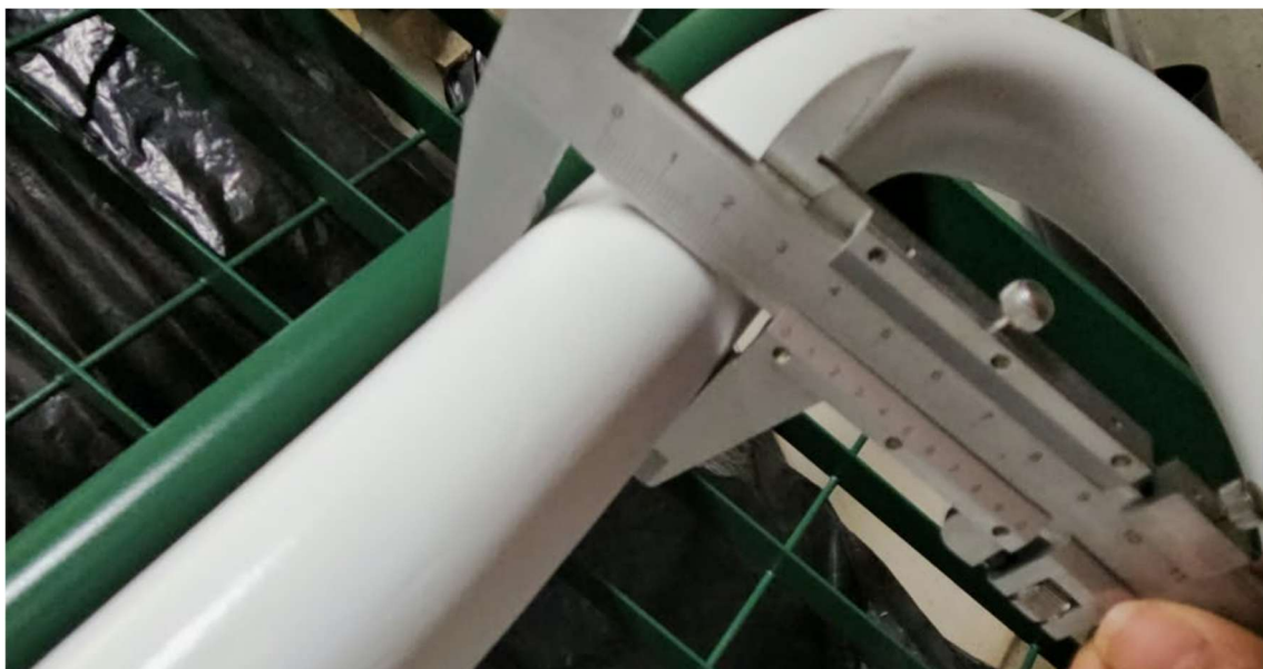
Foto 08 – Conferência dimensional pontual com paquímetro.
